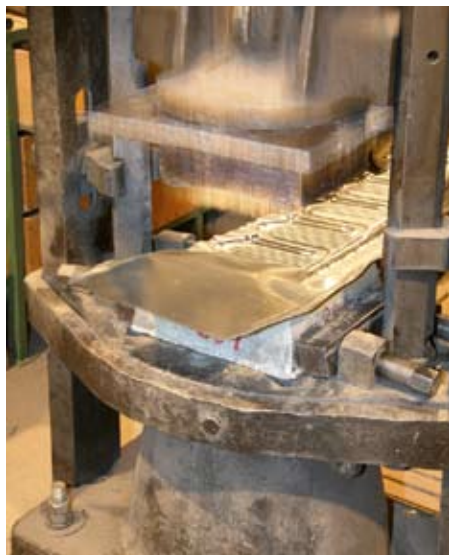
Thomas Mitter und Rainer Hummel kennen den Gießerei- und Stanzbereich der Kaufmann-Ornamentenabteilung in- und auswendig. Am „Ulmer Fallwerk“ fertigen sie unterschiedlichste Profile
