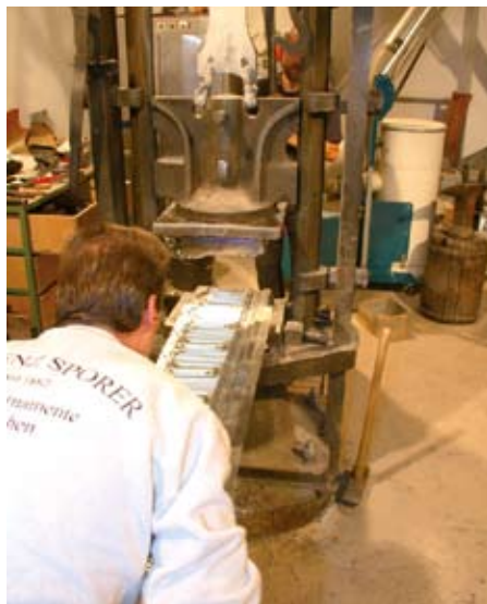
Thomas Mitter und Rainer Hummel kennen den Gießerei- und Stanzbereich der Kaufmann-Ornamentenabteilung in- und auswendig. Am „Ulmer Fallwerk“ fertigen sie unterschiedlichste Profile
